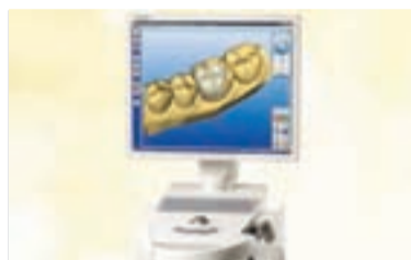
Sken kvadrantu s preparací zhotovený složením jednotlivých snímků pro dosažení 3D obrazu
